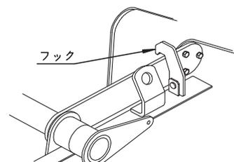
(2) トラクタをアイドル状態で外部油圧を操作します。ゲートが1/4程度開いたところでストップバルブを閉じます。
