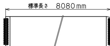
レーシングピンは2000梱包毎に交換してください。ベルト交換が終了後「5-3-11 ベルトアライメントの調整」の説明に基づき調整してください。
