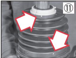
⑪ カバーとベアリングリングの基準ピンが穴に合っていて、基準ピンがきちんと挿入されていることを確認します。カバー固定のプラスネジを締めます。電動ドライバーは使用しないでください。
