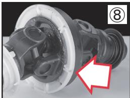
⑧ CVヨークのベアリング溝にグリースを塗り、基準ピンを内側に向けて、ベアリングリングを溝に取り付けます。
