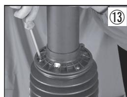
⑬ プラスネジを締めます。電動ドライバーは使用しないでください。
