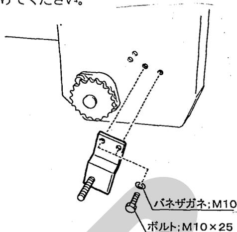
3. カバーアッセをボルトに通し、スプロケットにチェーンを掛けたまま、ボスの向きに注意して組み込んでください。
