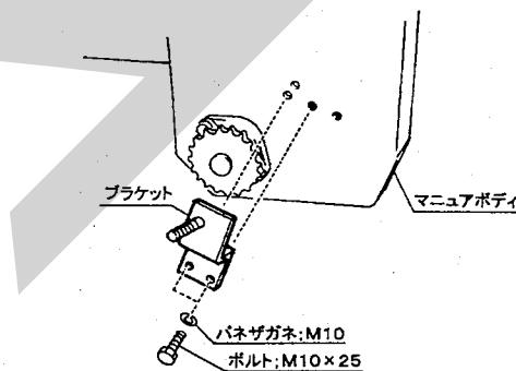
3. カバー・アッセイをボルトに通し、スプロケットにローラーチェーンを掛けたまま、ボスの向きに注意して組み込んでください。
