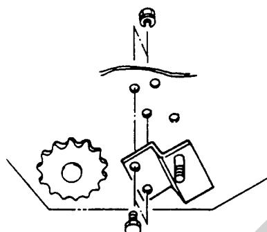
5. カバーーアッセイをボルトを通してスプロケットにローラチェーンを掛けたままボスの向きに注意して組み込んでください。
