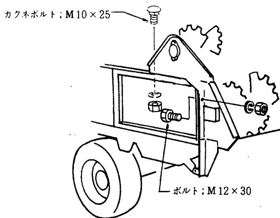
4. ブラケットをワゴンボディとビータフレームに組み付けてください。
