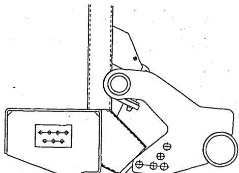
② ポイントをフレームに固定しているフックがもどらないようデルタピン (A) にて固定しています。
