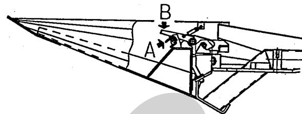
③ ポイント先端を片手で持ち上げぎみにし、もう一方の手でフックのレバー（B）を下げます。レバーを下げたまま、ポイント先端を下げ、両手でポイント前後を持ち上げ前方へ引き出します。
