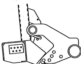
② ポイントをフレームに固定しているフックがもどらないようデルタピン（A）にて固定しています。
