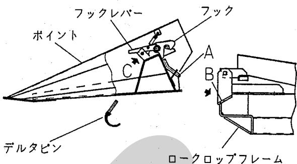
② ポイントがロックされたことを確認し、デルタピンを (C) 部に差し込み固定します。デルタピンを差し込む時、ピンスプリングがバランスする位置まで開いてから差し込むと作業がし易くなります。
