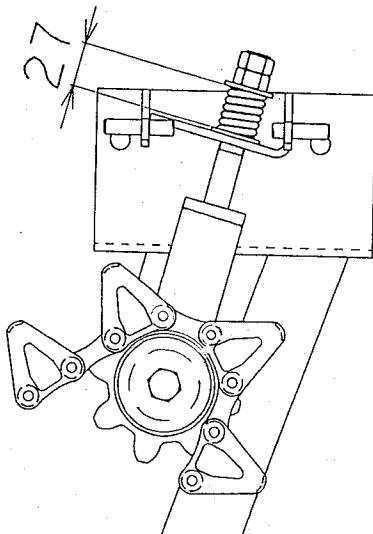
(4) 内側ギャザリングチェーンの張りは図示の通り27mmになるように調整します。
