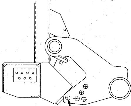
② ポイントをフレームに固定しているフックがもどらないようデルタピン (A) にて固定しています。
