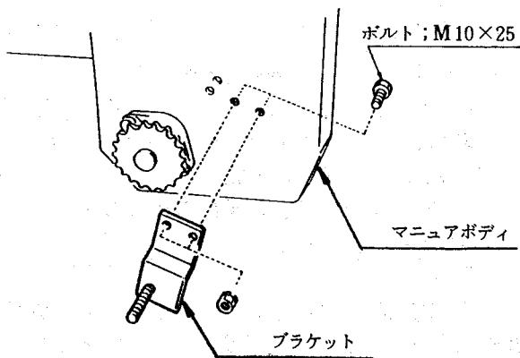
4. カバーをボルトに通し、スプロケットにチェーンを掛けたまま、ボスの向きに注意して組み込んでください。
