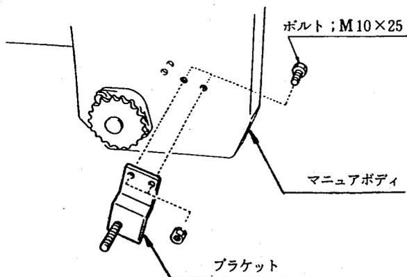
4. カバーアッセをボルトに通し、スプロケットにチェーンを掛けたまま、ボスの向きに注意して組み込んでください。
