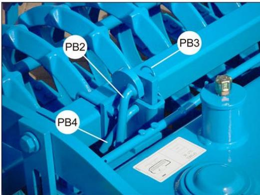
偏芯レバー（PB2）を使ってがっしり作られたレベリングバーを簡単に調整できます。偏芯レバーはレバーが抜け落ちないようにリンチピンで抜け止めしなければなりません。ピン（PB4）は調整前にはずして、レベリングバーが偏芯レバー（PB2）で持ち上げられたときに差し込んでください。
