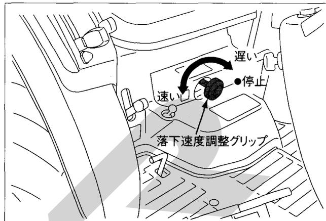
落下速度が速すぎるとスムーズに下がらないときがあります。スムーズに下がるように落下速度を調整してください。
