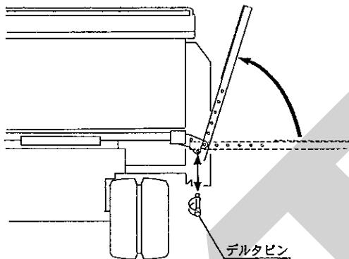
実際にデルタピンを両方の穴に通し、キャンバスカバーを固定してください。
