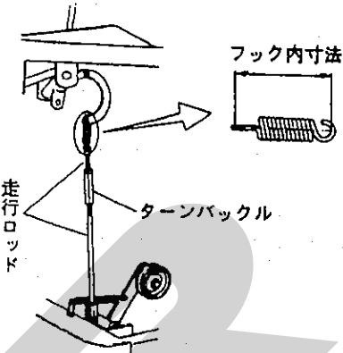
(2) ターンバックルで調整しきれない場合は、エンジン取り付けボルトをゆるめ、エンジンを移動させてください。
