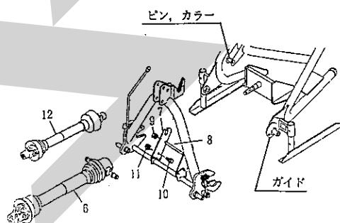
(6) ロワーリンクの地上高が40cm位で、オートヒッチフレームの姿勢が後傾5°位になるようにトップリンクの長さを調整してください。
