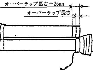
⑤ 3点リンクを昇降させて、PTO軸とPIC軸が最も離れる位置で、昇降を停止してください。
