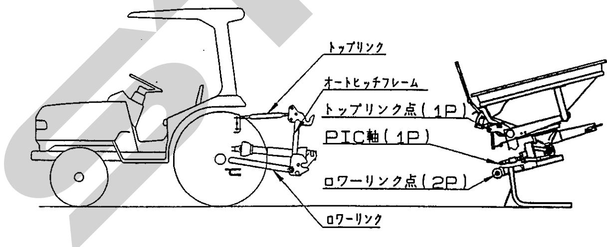
(3) JIS規格により、トラクタ3Pの寸法が規定されており、「0・I兼用」タイプと「I・II兼用タイプ」があります。オートヒッチにもこの2種類があり、一般的に「0・I兼用」タイプは「S」、「I・II兼用タイプ」は「L」で区分しています。
