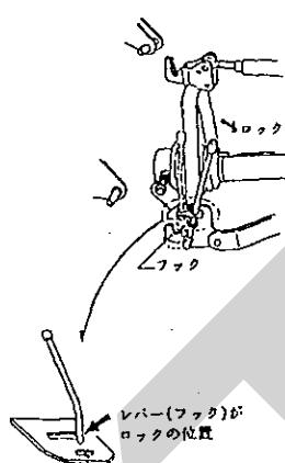
(11) P I C軸芯がトラクタ中心におおよそ一致するようにチェックチェーンでセットし、ブロードカスタの横振れをなくしてください。
