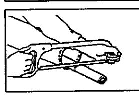
(4) 切り口をヤスリなどでなめらかに仕上げてからパイプをよく清掃し、次にグリースを塗布して、アウタとインナを組み合わせます。
