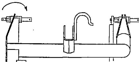
(5) 作業機の3Pフレームをトラクタ3点リンクで持ち上げた時、3Pフレームがほぼ垂直に上がるようすに作業機のトップリンクpin穴位置を選んでトップリンクを連結し、抜きごとめに作業機についているベータpinを差してください。
