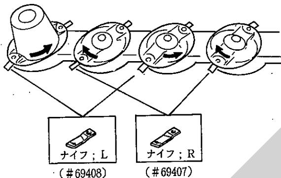
ナイフボルト、ナイロンナットを締付ける時はディスクに回り止めを当て、締付けトルク50 N・m (=500kg・cm) でしっかりと締付けてください。
