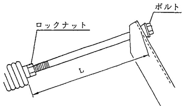
(2) 土手などののり面でカッターバーを水平位置から30°以上下向きにして作業する時は、上記標準寸法より50～100mm長くなるよう調整してください。
