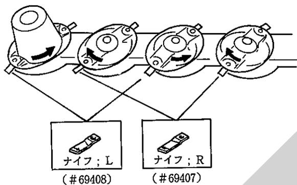
ナイフボルト、ナイロンナットを締付ける時はディスクに回り止めを当て、締付けトルク50 N・m (=500kg・cm) でしっかり締付けてください。
