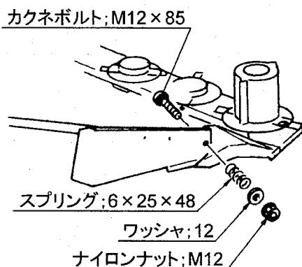
スプリング； $6 \times 25 \times 48$ の取付け寸法はH=42mmが標準です。
