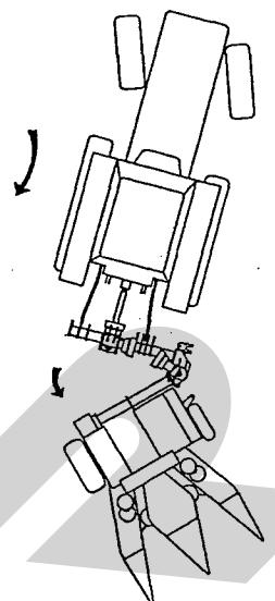
(3) 本体と3点フレームが90°開いたら、トラクタの外部油圧を旋回用シリンダが伸びる方向に操作しながら、サイド状態になるまでバックします。
