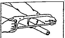
切断する時は、パイプの中にウエスを詰め、パイプの内面に切り粉が付着するのを防いでください。
