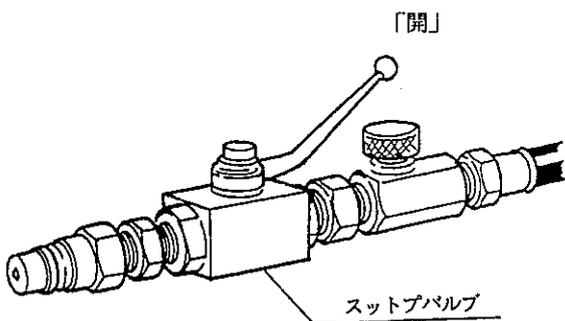
5. トラクタ油圧（外部取出）を操作し、ロータを折りたたみます。
