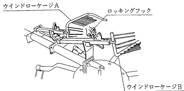
5. トラクタ油圧（外部取出）を操作し、ロータを折りたたみます。
