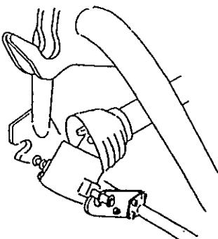
(9) オートヒッチフレーム上部ガイド（フック部）がトップリンク部をすくい上げができる位置までトラクタをジャイロレーキ中心に向けて、ゆっくりバックさせます。
