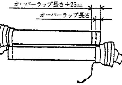
⑤ 3点リンクを昇降させて、PTO軸とPIC軸が最も離れる位置で、昇降を停止してください。
