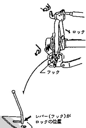
(11) PTO軸芯がトラクタ中心におおよそ一致するようにチェックチェーンでセットし、ジャイロレーキの横振れをなくしてください。
