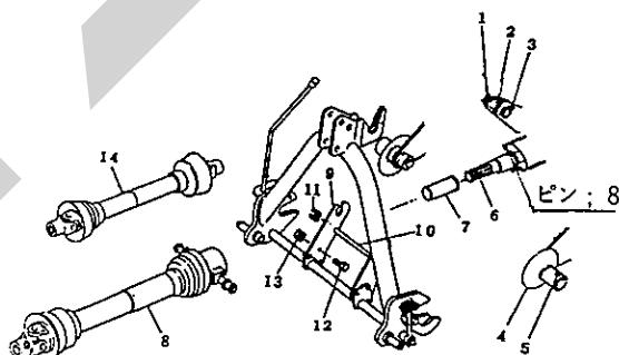
(7) ロワーリンクの地上高が40cm位で、オートヒッチフレームの姿勢が後傾5°位になるようにトップリンクの長さを調整してください。
