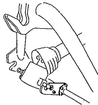
(9) オートヒッチフレーム上部ガイド（フック部）がトップリンク部をすくい上げができる位置までトラクタをジャイロレーキ中心に向けて、ゆっくりバックさせます。
