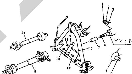
(7) ロワーリングの地上高が40cm位で、オートヒッチフレームの姿勢が後傾5°位になるようにトップリンクの長さを調整してください。
