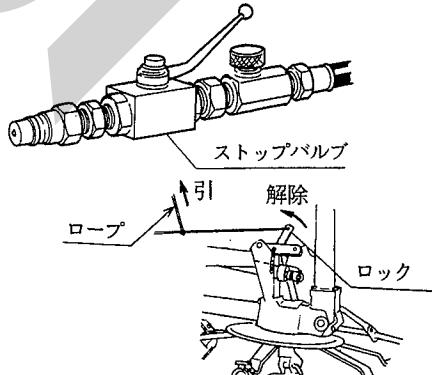
2. トランクタ油圧（外部取出）を操作し、ロータを広げてください。
