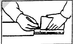
(3) パイプのアウタとインナ両方を金ノコまたはカッターで切断します。切断する時は、パイプの中にウェスを詰め、パイプ内面に切り粉が付着するのを防いでください。
