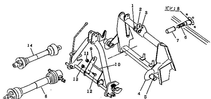
(5) ロワーリングの地上高が40cm位で、オートヒッチフレームの姿勢が後傾5°位になるよう にトップリンクの長さを調整してください。
