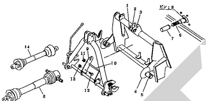
(5) ロワーリンクの地上高が40cm位で、オートヒッチフレームの姿勢が後傾5°位になるようトップリンクの長さを調整してください。
