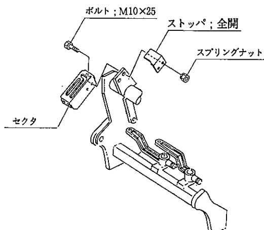
(3) 図を参考にして、3Sの場合、符号1~5を、0S、4Sの場合符号1~6をライムソーワ本体に組み付けしてください。
