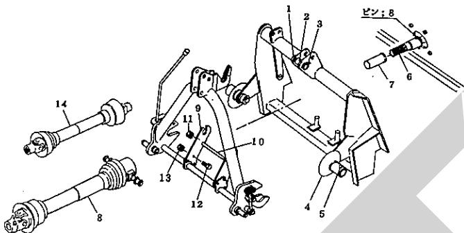
(5) ロワーリンクの地上高が40cm位で、オートヒッチフレームの姿勢が後傾5°位になるようにトップリンクの長さを調整してください。
