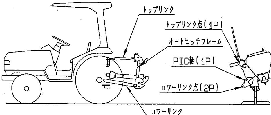
(3) J I S規格により、トラクタ3Pの寸法が規定されており、「0・I兼用」タイプと「I・II兼用タイプ」があります。オートヒッチにもこの2種類があり、一般的に「0・I兼用」タイプは「S」、「I・II兼用タイプ」は「L」で区分しています。
