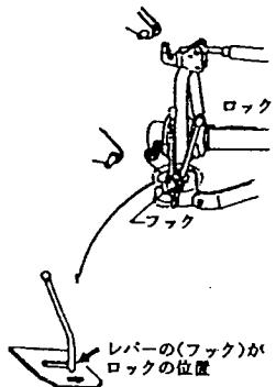
(8) ロータカバースタンド取付部の下のデルタピンを取りはずし、スタンドを上に上げ、上の穴でスタンドを固定してください。
