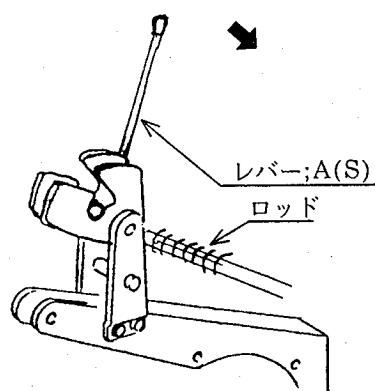
(3) 土寄せ作業を終えて代かき作業をする場合、トラクタの油圧操作レバーを操作し、作業機を持ち上げ、レバー；A (S) を前方に倒します。そのまま、作業機械を下げるとき、レバー；A (S) は自動的に元の代かき作業位置に戻ります。
