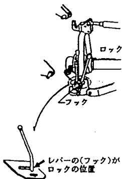
(8) ロータカバースタンド取付け部の下のデルタピンを取りはずし、スタンドを上に上げ、上の穴でスタンドを固定してください。
