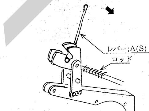
(3) 土寄せ作業を終えて代かき作業をする場合、トラクタの油圧操作レバーを操作し、作業機を持ち上げ、レバー; A (S) を前に倒します。そのまま、作業機械を下げると、レバー; A (S) は自動的に元の代かき作業位置に戻ります。
