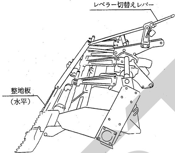
② 左右のサブフレーム側のロータクラッチの凹部上方にセットしてください。
