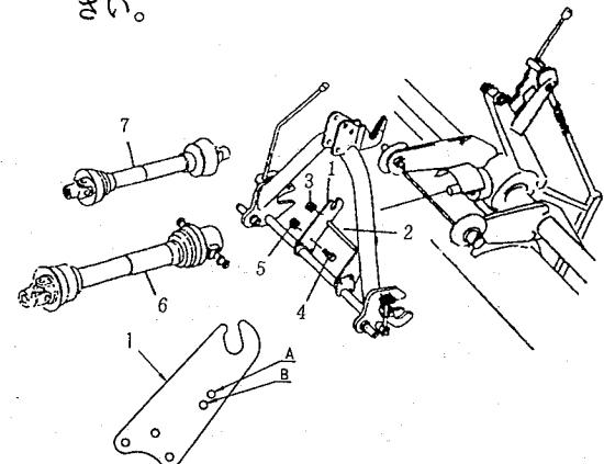
(3) ロワーリンクの地上高が35cm位で、オートヒッチフレームの姿勢が垂直になるようにトップリンクの長さを調整してください。
