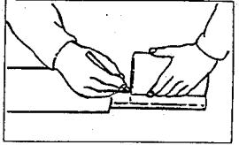
(3) パイプのアウタとインナの両方を金ノコまたはカッターで切断します。切断する時はパイプの中にウエスを詰めパイプ内面に切り粉が付着するのを防いでください。
