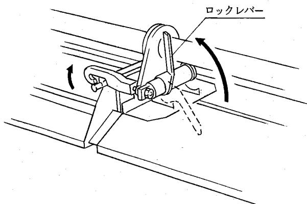
(11) ロックレバーを下方に押し下げ、ロックしてください(矢印の方向)。
