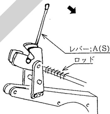
(3) 土寄せ作業を終えて代かき作業をする場合、トラクタの油圧操作レバーを操作し、作業機を持ち上げ、レバー ; A (S) を前方に倒します。そのまま、作業機を下げると、レバー ; A (S) は自動的に元の代かき作業位置に戻ります。
