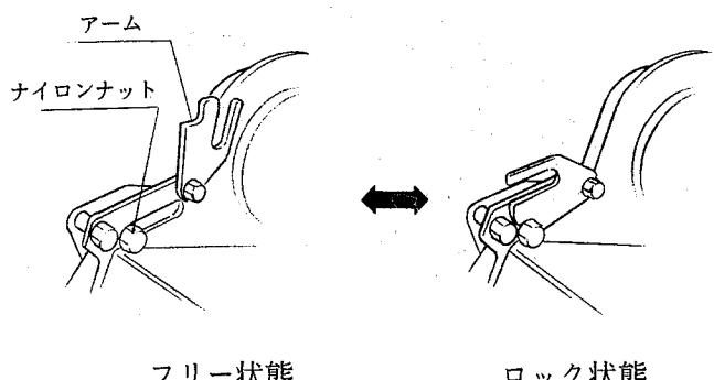
耕深コントロールを使用する時はローリングをロックしてください。
