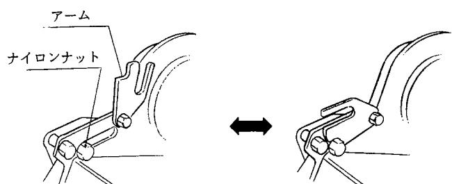
耕深コントロールを使用する時はローリングをロックしてください。
