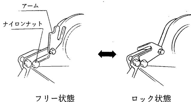
耕深コントロールを使用する時はローリングをロックしてください。
