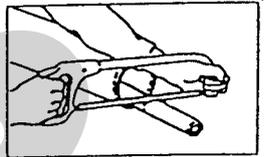
切断する時はパイプの中にウエスを詰め、パイプ内面に切り粉が付着するのをふせいでください。
