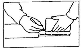
(3) パイプを金ノコまたはカッターでアウト・インナの両方を切断します。
