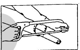
切断する時はパイプの中にウエスを詰め、パイプ内面に切り粉が付着するのをふせいでください。
