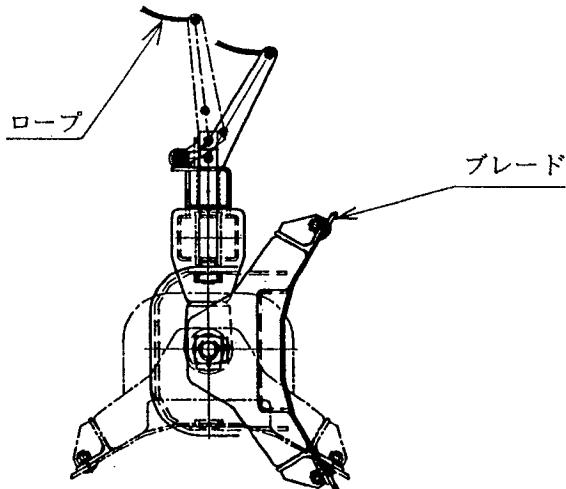
(2) ブレード面を前進方向に向けるときは、外部油圧を操作し、油圧シリンダが最短になるまで縮めます。
