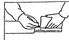
(3) パイプのアウトとインナ両方を金ノコまたはカッターで切断します。
