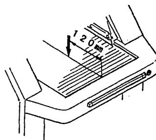
(1) コンペアベルトの張りは、テーブル側コンペア開口部より約 120 mm の位置で、コンペアベルト中央部を 5 kgf の力で押し、7~8 mm たわむ状態が適正です。
