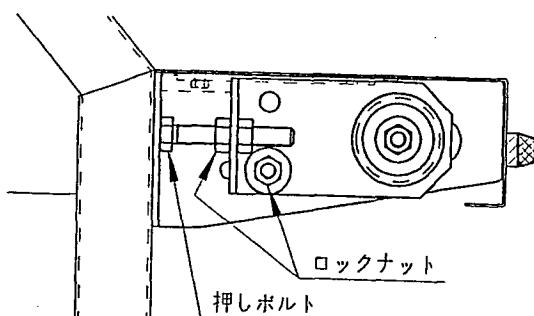
(2) ロックナットを緩め、押しボルトで調整してください。左右の押しボルトは、均等な長さにしてください。
