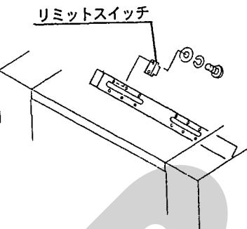
ペール端部へのトワイン巻付位置は、トワイン結束装置部トワイン送りカーソル左右のリミットスイッチの取付け位置変更で行います。
