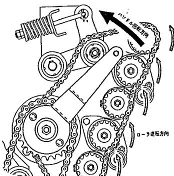
供給物がローラにからみついた時、ローラを逆回転させ、除去し易くします。
