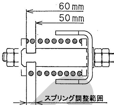
(3) ダブルナット；2を緩め、スプリング長さを調整します。スプリング下端面をゲージ切欠部の範囲内で調整します。
