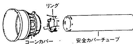
① ドライバーでコーンカバー3穴よりリングのツメを押して、コーンカバーを取り外してください。
