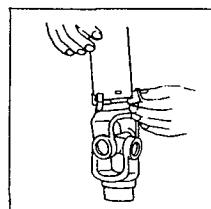
③ リングとコーンカバーのグリース穴を合せながら、コーンカバーを取り付けてください。
