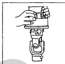
④ コーンカバーを軽くたたき、3つのツメがコーンカバーに確実にはまっていることを確認してください。
