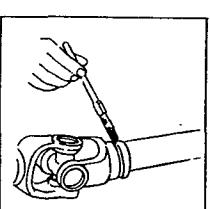
② リングを止溝にはめ込み、安全カバーチューブを取り付けてください。
