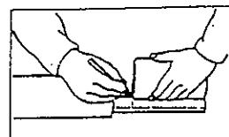
(3) パイプのアウタとインナ両方を金ノコまたはカッターで切断します。
