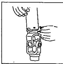
③ リングとコーンカバーのグリース穴を合わせながら、コーンカバーを取り付けてください。
