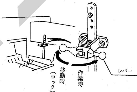
4. サイドリールに取付けているベータピンをはずし、ロッドの穴を上の穴から下の穴にし、サイドリールを下げベータピンを取付けてください。
