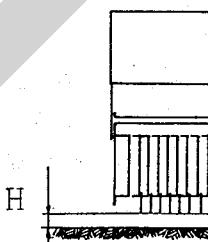
ほ場状態によるピックアップタインの地上高の微調整は、トラクタロワーリングの昇降によって行ってください。
