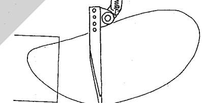
なおかつ調整しきれない高水分の牧草および切ワラ(12cm以下)の時は、フォーク(a)(b)をAの穴からBの穴へと取付けを変えることでさらに調整できます。
