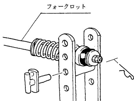
① 本作業機の後方から見て、右側の密度が高く、左側の密度が低い変形梶包が発生した時は、フォークロットの位置を下にしてください。(長い草や、わらの時発生しやすい。)
