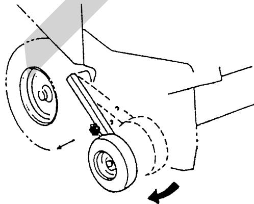
4. ピックアップロックのレバーでロックを解除し、ピックアップが上下に浮動するようにしてください。
