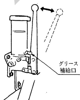
(2) グリースが完全に給油されたかどうかの確認は分配弁の指示棒の往復運動によって確認することができます。図示の指示棒が1往復すれば、すべての軸受部に給油が完了したことを示します。
