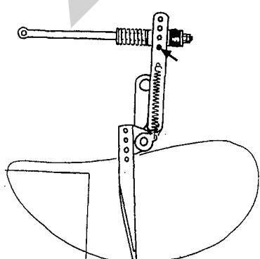
② 本作業機の後方から見て、左側の密度が高く、右側の密度が低い変形梶包が発生した時は、フォークロットの位置を上にしてください。(短い草や水分の高い時、発生しやすい。)
