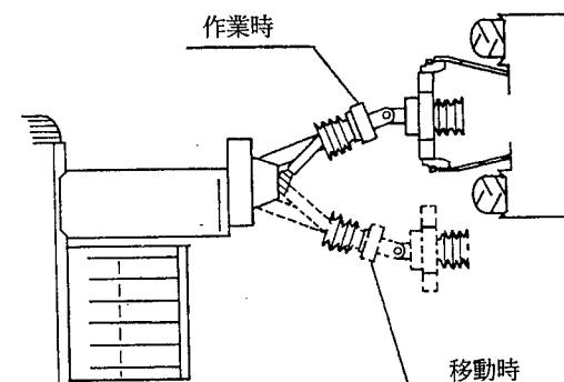
6. トラクタロワーリングをパワージョイントが抜けない上限位置まで持ち上げてください。
